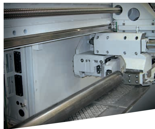
Pince de tri et d'amenage matière.
