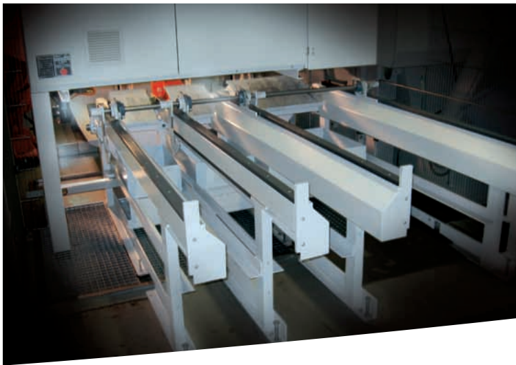
Tri des tronçons de grande longueur à l'intérieur de la machine.
