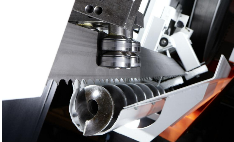
Convoyeur à vis dans la tête de sciage avec brosse à copeaux double.
