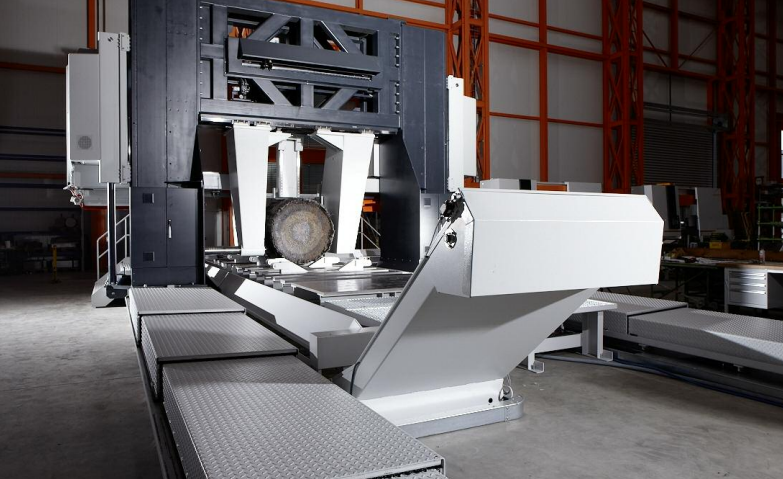
Evacuateur à copeaux, largeur de transport 1.250 mm, hauteur d'éjection 1.100 mm.
