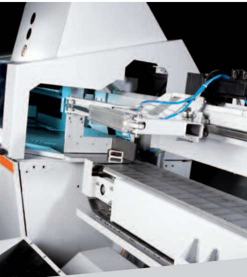
Pousseur pour les coupes KASTOflex F
