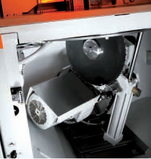
Bonne accessibilité pour un changement rapide de lame
