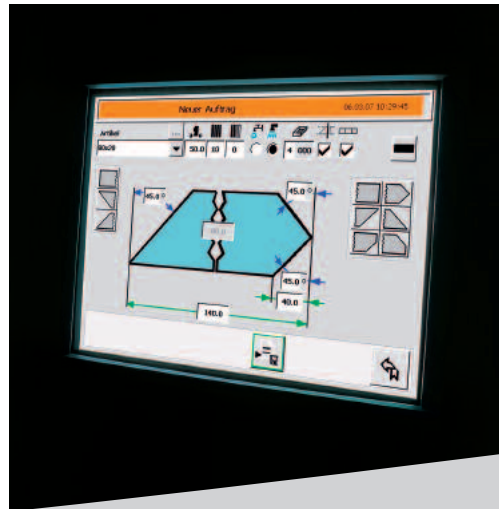
Commande KASTO EasyControl sur la KASTOflex F : Saisie de la commande avec représentation graphique de la coupe biaisée
